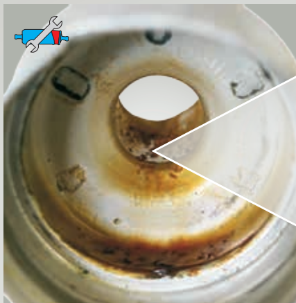
Fig. 64 : Dépôts cristallins dus à l'emploi d'un produit non homologué La cause exacte de ce genre de dépôts ne peut être détectée qu'au cas par cas et après analyses chimiques très poussées.
