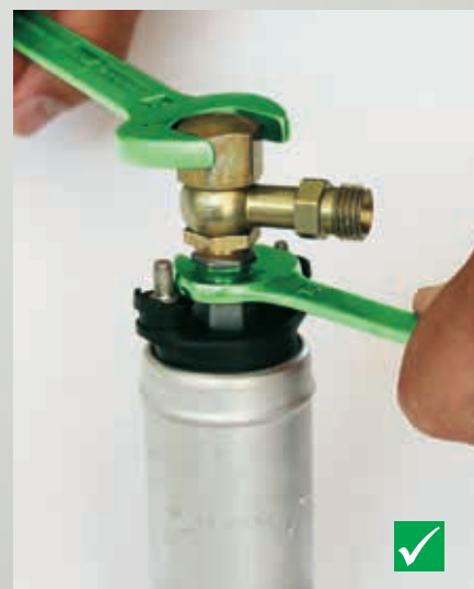
Fig. 71 : Montage correct : il faut contrer le six pans inférieur de la pompe à carburant
