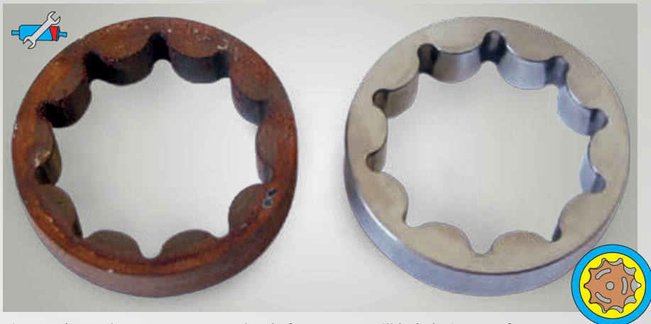
Fig. 48 : à gauche : engrenage trochoïde fortement rouillé ; à droite : neuf
