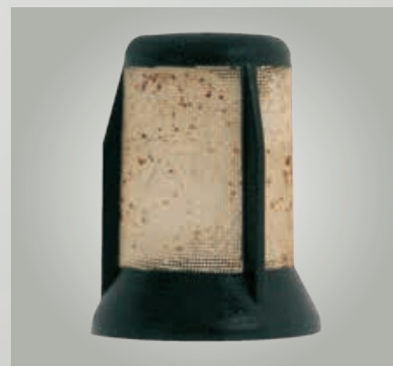
Fig. 23 : Filtre-tamis encrassé sur une pompe à engrenage E3T
