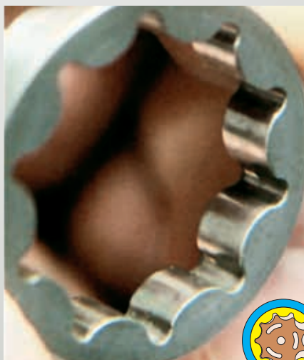
Fig. 51 : Engrenage trochoïde (à gauche avec des dépôts calcaires, à droite, neuf)
