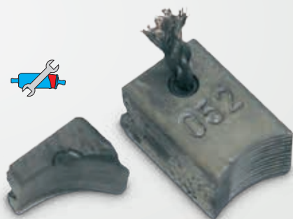
Fig. 62 : Charbons après env. 15 000 km à gauche : usure prématurée à droite : état normal pour ce kilométrage
