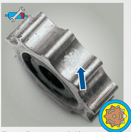
Fig. 49 : Engrenage trochoïde avec dépôts calcaires
