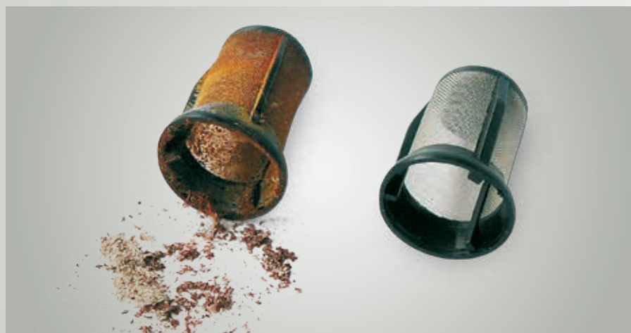
Fig. 41 : à gauche : filtre-tamis colmaté par la rouille ; à droite : filtre-tamis neuf
