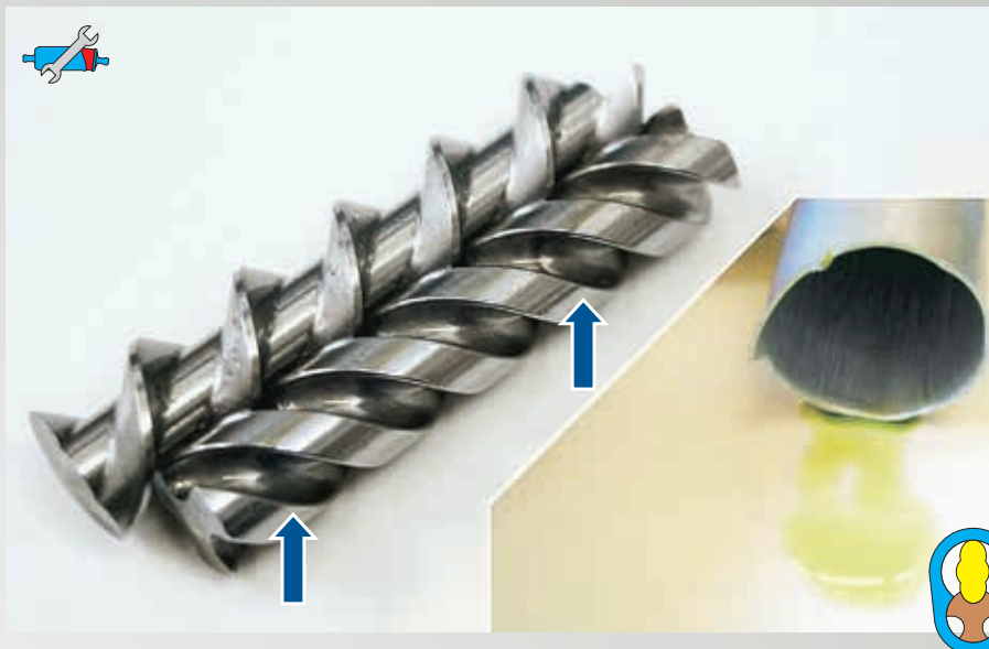
Fig. 55 : Calaminage dû à l'emploi d'un produit non homologué La photo montre le mécanisme d'une pompe à vis de type E3L. Les restes d'un liquide vert s'écoulent encore du boîtier découpé pour les besoins de l'analyse. Le mécanisme de la pompe a été calaminé par ce « carburant ». L'endroit où les deux spirales de refoulement de la pompe se sont collées est parfaitement visible (flèche) aux dépôts sur une des spirales.
