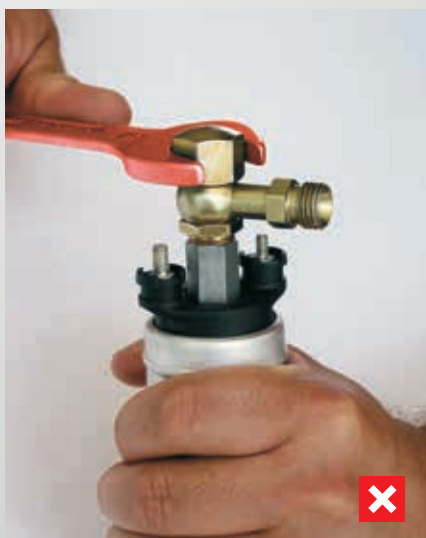
Fig. 70 : Mauvais montage : Serrer sans contrer
