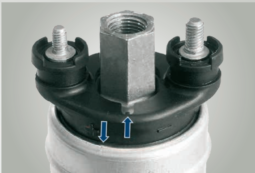
Fig. 69 : Couvercle de pompe mal placé
