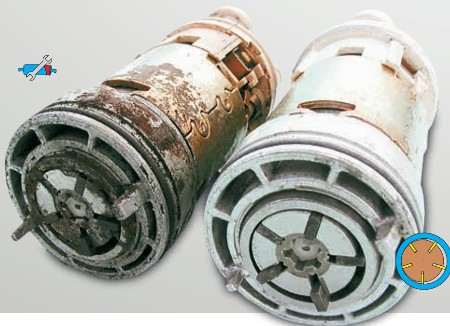
Fig. 36 : Dégâts causés par l'eau sur une pompe à ailettes.
