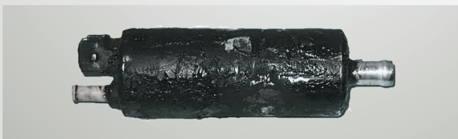
Fig. 65 : Pompe en ligne ayant été utilisée comme pompe immergée.
