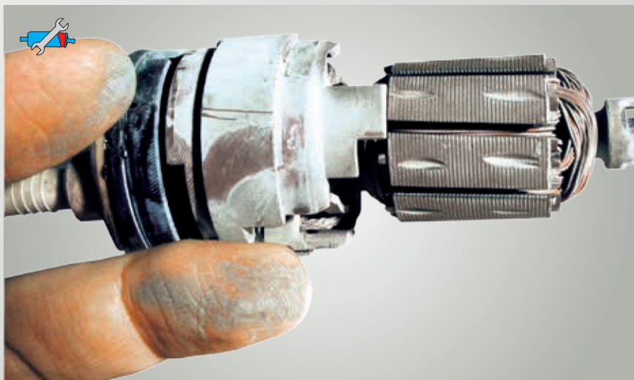
Fig. 56 : Dépôt de carburant de mauvaise qualité
