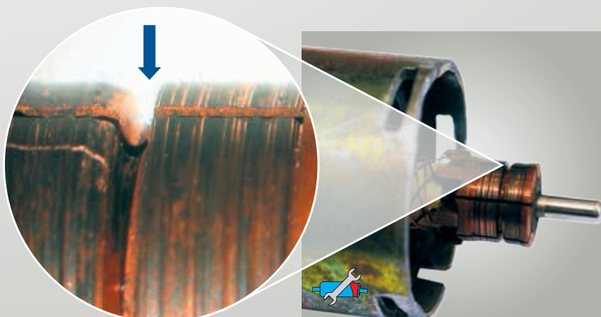
Fig. 62 : Charbons après env. 15 000 km à gauche : usure prématurée à droite : état normal pour ce kilométrage
