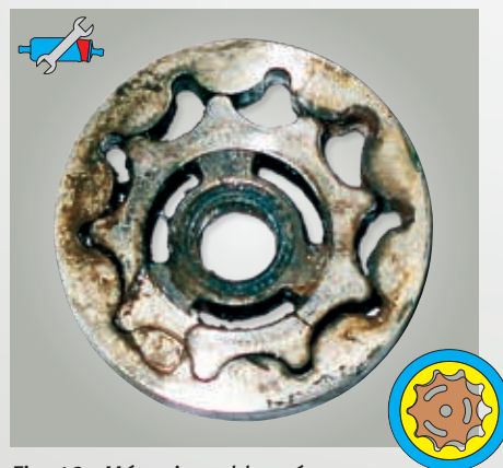
Fig. 19 : Mécanisme bloqué (engrenage trochoïde) d'une pompe à engrenage E3T
