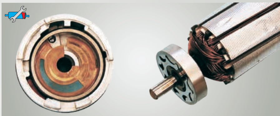
Fig. 38 : Par comparaison : pompe à engrenage E3T – en bon état, malgré une longue période de service
