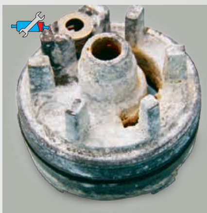
Fig. 50 : Palier extérieur rouillé d'une pompe à carburant
