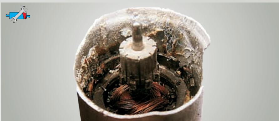
Fig. 16 : Pompes à carburant électrique fortement rouillées
