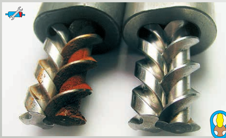
Fig. 54 : Pompe à vis (à gauche, rouillée, à droite, neuve)
