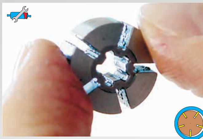
Fig. 30 : Mécanisme encrassé d'une pompe à ailettes Le rotor est tellement encrassé que les différentes ailettes (enlevées ici) ne peuvent plus bouger. La pompe « tourne » toujours, mais elle ne débite plus.
