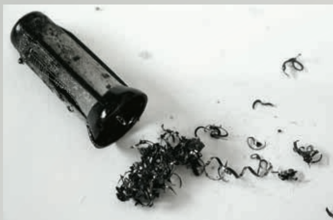
Fig. 29 : Copeaux métalliques dans le filtre-tamis. Des copeaux métalliques sont tombés dans le réservoir au cours de travaux sur le système d'alimentation en carburant. Les copeaux tranchants ont détérioré le filtre-tamis. De cette manière, de la crasse peut pénétrer dans la pompe et bloquer son mécanisme.
