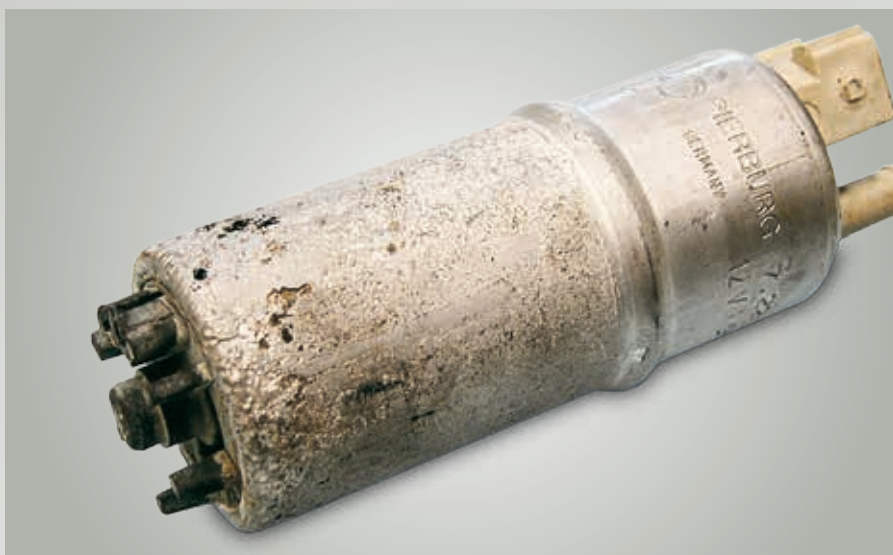
Fig. 72 : Rouille de contact à la suite d'une mauvaise association de matériaux
