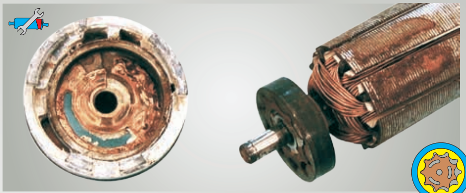
Fig. 37 : Pompe à engrenage E3T – attaquée par des dépôts de rouille et de calcaire
