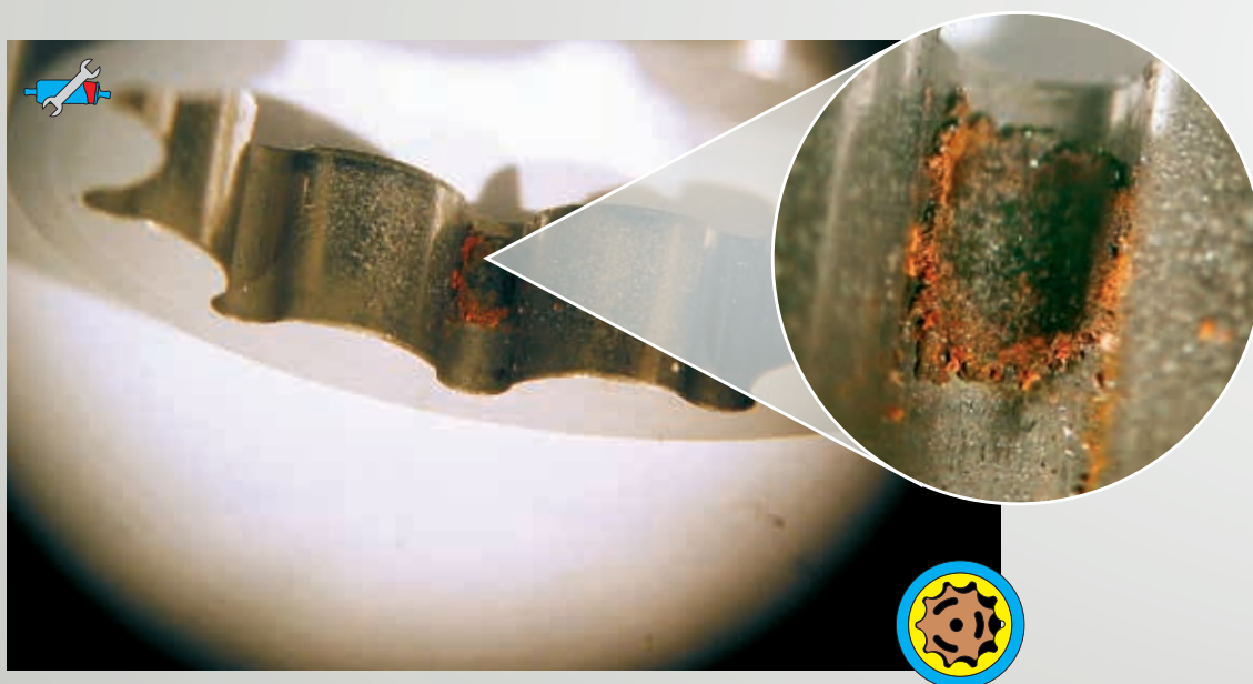
Fig. 47 : Engrenage trochoïde bloqué par des particules de rouille (agrandissement)
