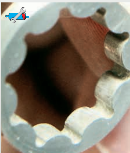
Fig. 51 : Engrenage trochoïde (à gauche avec des dépôts calcaires, à droite, neuf)
